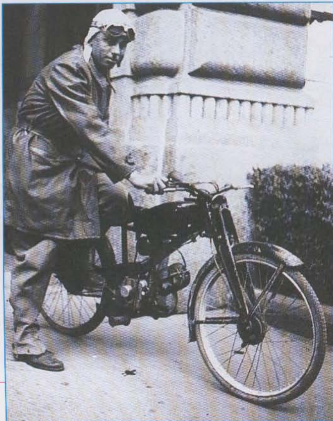
• Foto inedite del prototipo "65" con il volano esterno e il carburatore a destra.
