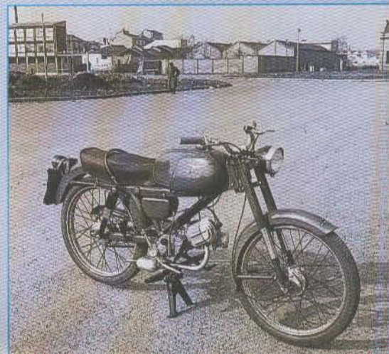
• L'ultima versione del Cardellino, quella del 1962, con il motore maggiorato a 83 cc. Il malinconico sfondo periferico sembra intonato alla prossima fine di questa motoleggera.
