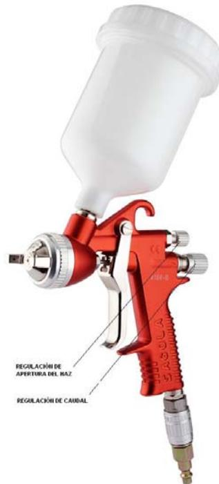
El gatillo de la pistola tiene una primera parte de su recorrido en la que sólo acciona el aire a presión, y una segunda parte en la que, conforme se presiona más, se abre más la aguja que da paso a la pintura. Este gatillo tiene un tope regulable, que evita que se dé más caudal de pintura del deseado por accidente.
