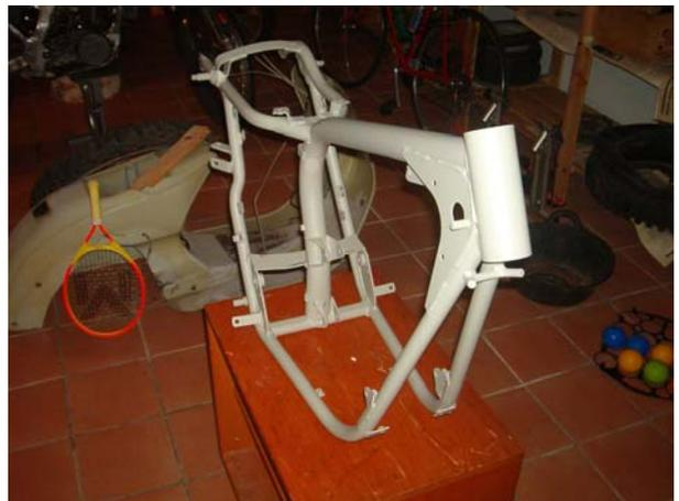
Determinadas marcas de pintura requieren antes de la capa de acabado, utilizar una imprimación específica. Estas imprimaciones suelen ser gruesas, de forma que cumplen la función del pintado de la pieza con aparejo.
