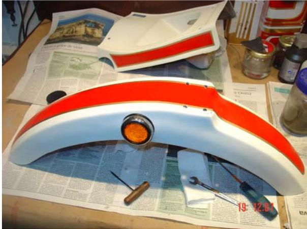
Es conveniente, antes de la aplicación del barniz, o entre diferentes capas de pintura, realizar un lijado fino llamado **mateado**. Este leve lijado produce una superficie mate, de aquí su nombre. Tiene como finalidad crear una adhesión mecánica entre la pintura de origen y la que será aplicada posteriormente.
