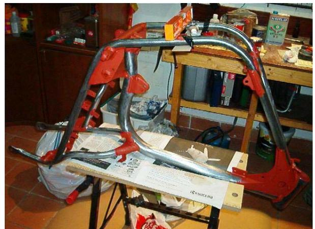
Para la aplicación de la imprimación, es recomendable aplicar antes a pincel en los rincones difíciles, uniones, soldaduras, etc, para asegurarse que la pieza queda bien protegida.
