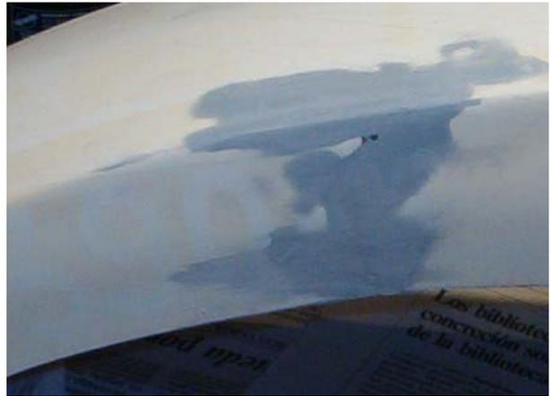
En cualquier caso, antes de la capa de acabado, se debe aplicar siempre un aparejo sobre las masillas, evitando de esta forma la posible aparición de defectos de pintado en forma de rechupados.
