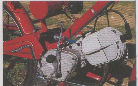
Large ailettes pour l'ensemble cylindre-culasse, immense levier d'embrayage et amortisseurs arrière en position horizontale sont quelques-unes des particularités techniques du Guzzino.
